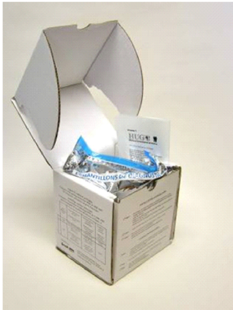
Photo 1 : exemple d'emballage de catégorie A, instruction d'emballage P620, norme classe 6.2 de l'ONU, UN2814 (ADR 2.2.62.1.4.1)
