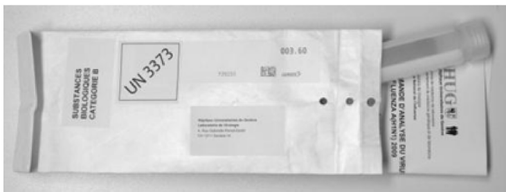
Photo 2 : exemple d'emballage souple et bon marché de catégorie B de type enveloppe, instruction d'emballage P650, UN3373 (ADR 2.2.62.1.4.2).
